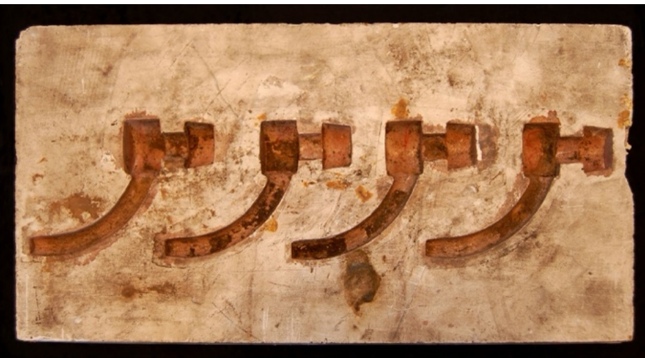
Molde de yeso para la elaboración de piezas metálicas.
