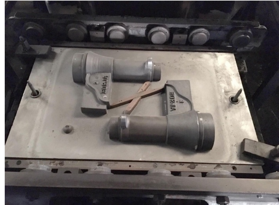
Placa modelo de cuerpo bomba jarro con dos huellas.
