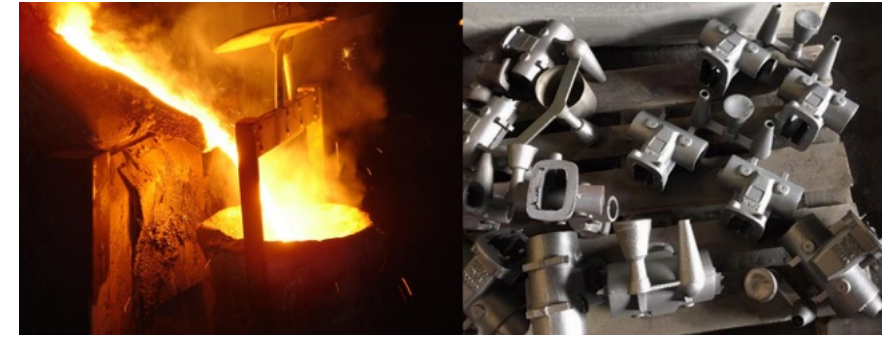
Colada de fundición y cuerpos de válvula granallados listos para rebarbar.
