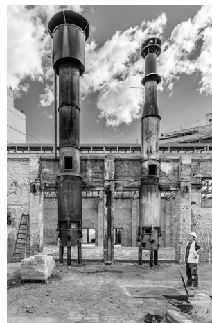
Hornos cubilotes para la fundición de la fábrica de Carlos Gens. Fotos: Frank Gómez y P. Berrocal Ruiz.
