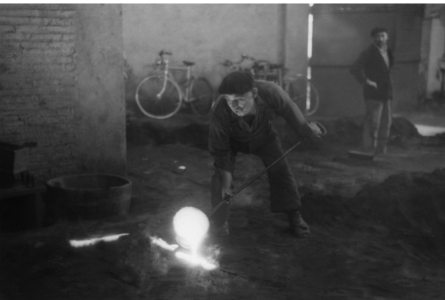
Imagen del interior de la fábrica en la que se muestra el momento del vertido del hierro fundido sobre los moldes. Foto: Colección Ángel Mompó.
