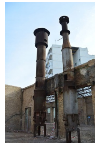
Hornos cubilotes para la fundición de la fábrica de Carlos Gens. Fotos: Frank Gómez y P. Berrocal Ruiz.
